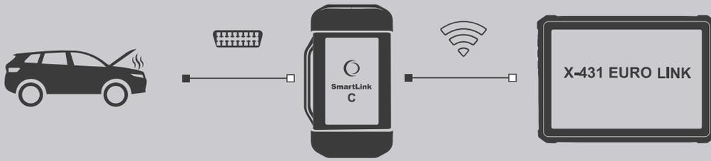
Veicolo difetto del cliente in loco presso la vostra officina o esternamente presso i servizi mobili. Collegate il dispositivo SmartLink al veicolo tramite la porta OBDII. LO SmartLink può comunicare con il
