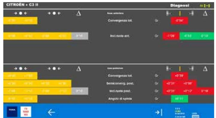
Schermata riepilogativa dei dati rilevati dai quattro sensori CCD, confrontati con i valori nominali stabiliti dal costruttore. Se i valori rientrano nelle tolleranze è possibile procedere al posizionamento di RCCS 3 BT.
