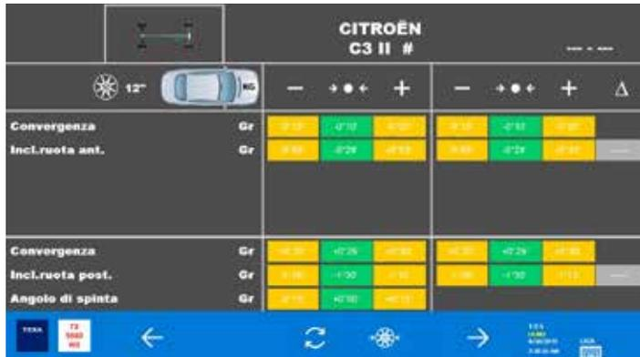
In fase di verifica dell'assetto il software consente di impostare il diametro degli pneumatici e mostra i range nominali di convergenza, semi-convergenza e l'angolo di spinta.
