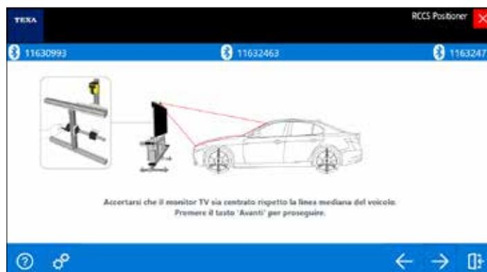
È necessario centrare il monitor TV rispetto al veicolo con l'uso dell'apposita microregolazione.
