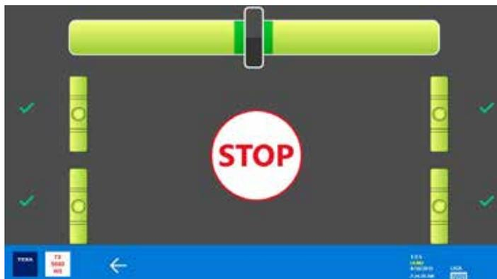
è necessario posizionare i 4 rilevatori CCD paralleli alla superficie di lavoro e centrare lo sterzo. Una volta soddisfatte queste condizioni viene visualizzata la scritta "STOP".
