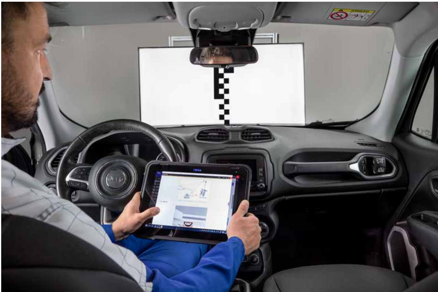
Le **immagini** dei pannelli vengono trasmesse e **posizionate in modo automatico**, in funzione della selezione del veicolo effettuata. La loro visualizzazione avviene attraverso un processo lineare, sicuro e veloce.
