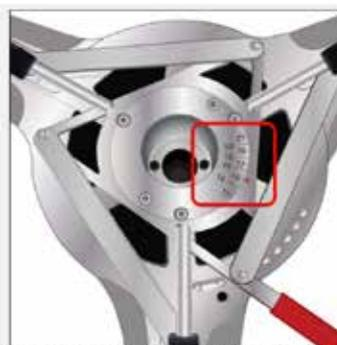
Immagine 2 - Gradi di ampiezza del centrassetto in base alle dimensioni della ruota.
