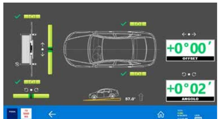
La struttura è allineata al veicolo in modo corretto ed è possibile procedere alla calibrazione del radar o della telecamera.
