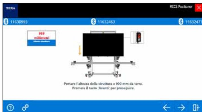
È necessario movimentare elettricamente la struttura per posizionarla all'altezza corretta.
