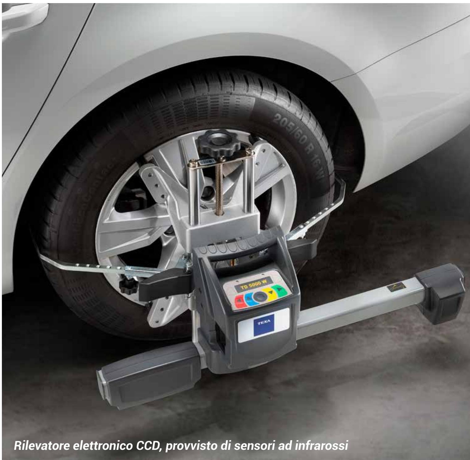
*Rilevatore elettronico CCD, provvisto di sensori ad infrarossi*
