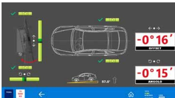
La dicitura "OFFSET" indica quanto l'RCCS 3 BT è fuori centro rispetto alla linea mediana del veicolo. "ANGOLO" indica invece di quanto l'angolo di imbardata della struttura è fuori centro rispetto al veicolo.
