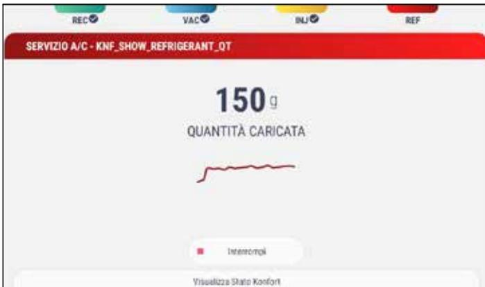
Fase «carica refrigerante»: la stazione provvede all'immissione della corretta quantità di gas nell'impianto del veicolo.
